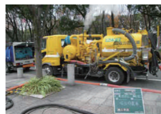
超強力濁水吸引・回収車 洗浄後の汚れを強力に吸引する真空バキューム車
