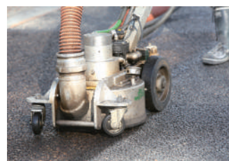
SJ-V 洗浄ユニット エアモーターによる回転洗浄で均一な施工を実現
