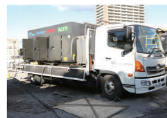
超高压水生成ポンプ車 洗浄ユニットへ超高压で送水する洗浄車
