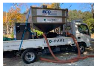
濁水処理車 吸引した汚水を排水基準値に処理する装置
