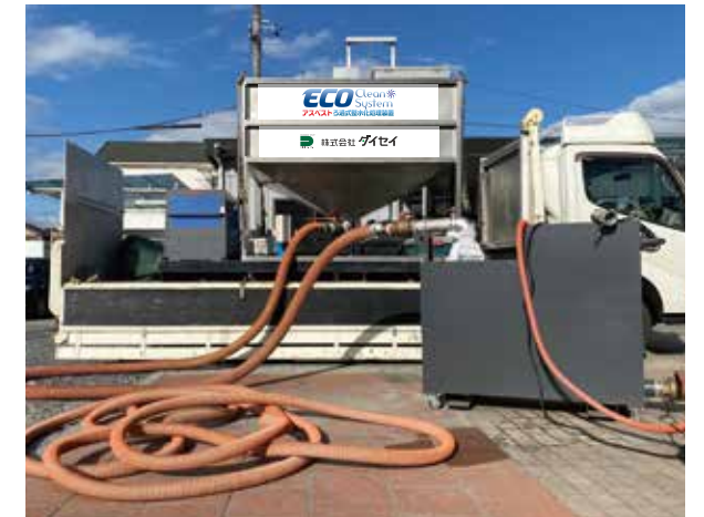
車載タイプの濁水を整水化するエコクリーンシステムの装置 機動力と現場のスペースを有効活用にも貢献します。
